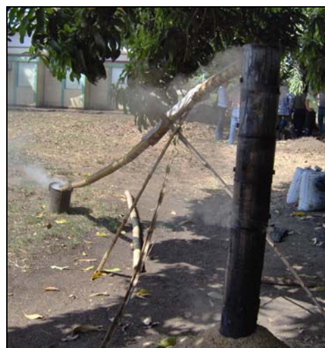
Evite la fuga de humo en la unión de los tubos Lugar: UNAN León
